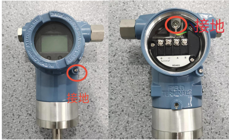
电缆屏蔽网接液位计的內部地；外接地接容器的地（大地）。
